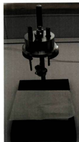
Figura 3.8 – Suporte adequado para montagem da bomba.
