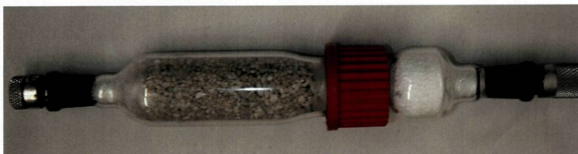
Figura 3.7 - Fotografia de um tubo de absorção pronto para ser utilizado.
