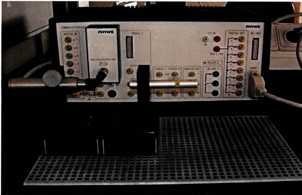
Figura 23 – Fotografia que representa o contador Geiger-Müller, a fonte de radiação usada e a interface.
