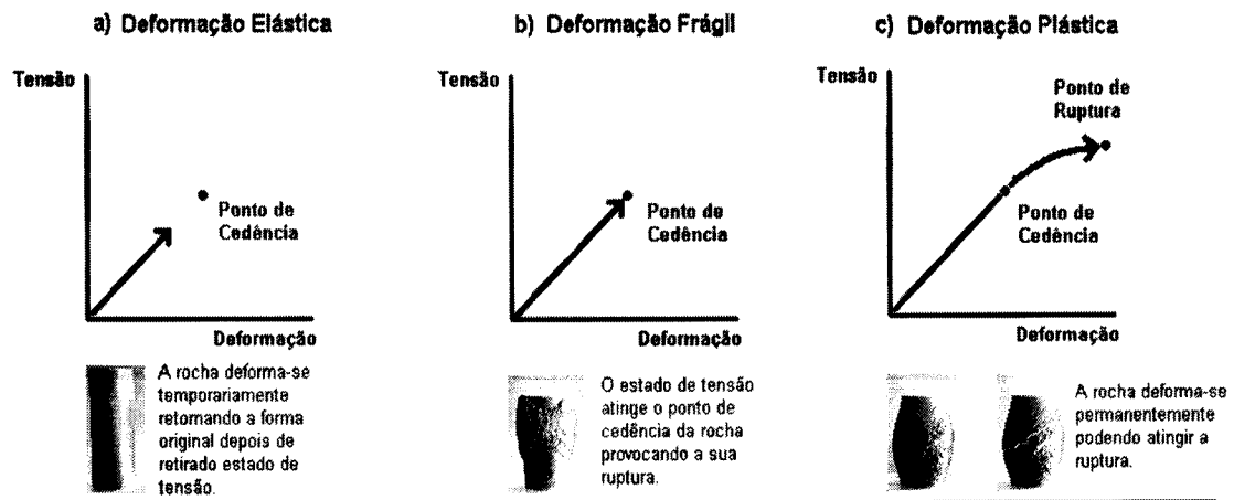
Figura 3.3. Relação entre estado de tensão e tipos de deformação produzida nas rochas. Adaptado de Chernicoff e Venkatakrishnan, 1995.
