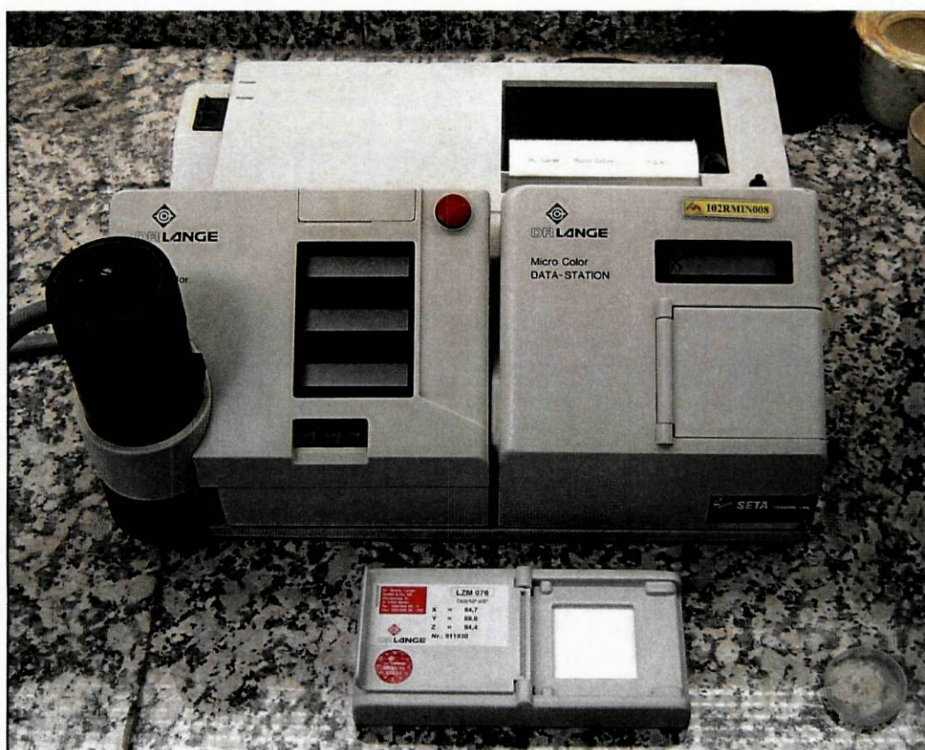
Figura 7.9 – Aspecto do colorímetro Micro Color II (V. 2.6) data station da Dr. Lange, utilizado no laboratório do INETI, em São Mamede Infesta.
