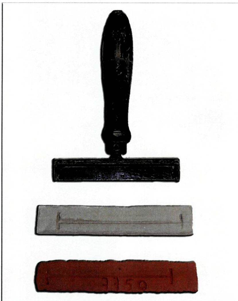
Figura 7.10 – Aspecto do punção e dos provetes (seco e cozido a 950°C) utilizados para quantificação da retracção.
