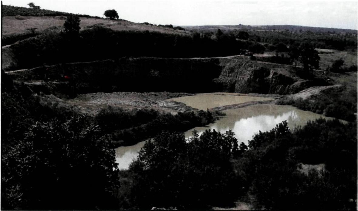
Figura 6.6 – Aspecto de uma frente de exploração do areeiro de Sendas e de um tanque de decantação dos resíduos produzidos.
