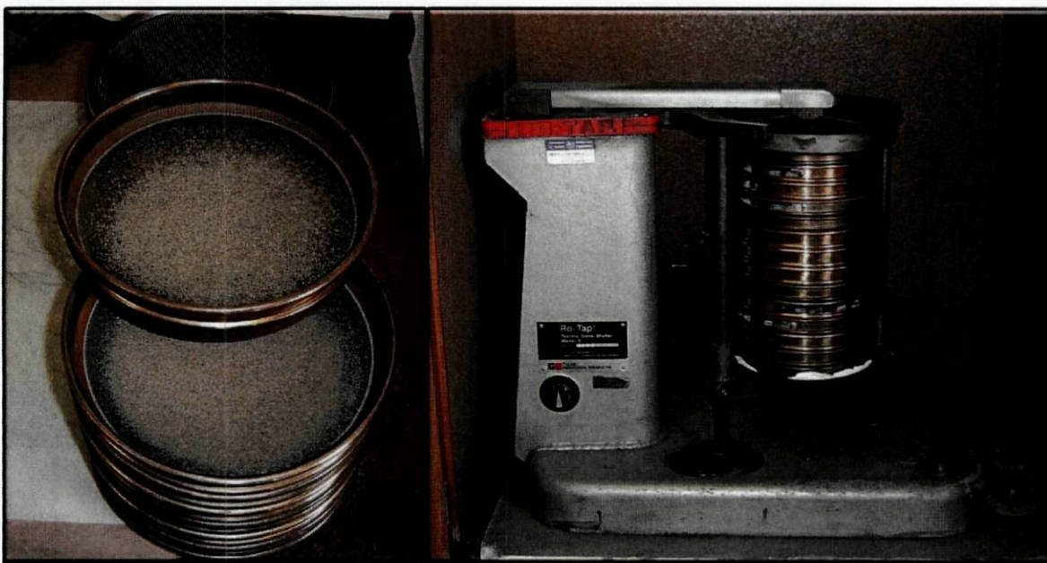
Figura 7.1 – Crivos da série ASTM E11 e agitador mecânico Ro-Tap (modelo B), utilizados no laboratório de sedimentologia do DCT-UM, para análise dimensional da fracção > 63 \mu\text{m} .
