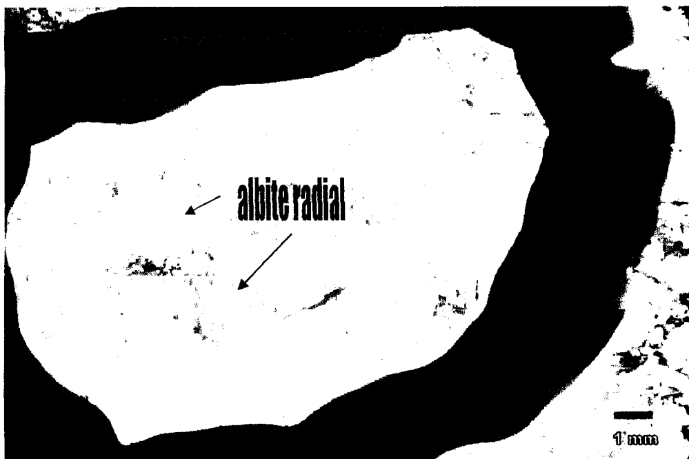
Foto 39 – Aspecto da petalite com inclusões de albite radial.
