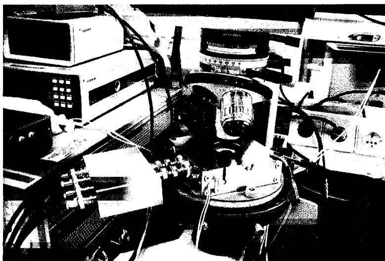
Figura 3.18. Montagem utilizada para a determinação dos parâmetros associados às propriedades dieléctricas.
