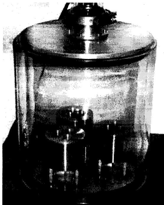
Figura 3.6- Fotografia da câmara de vácuo, contendo no interior os três fornos, que por sua vez contêm as células de efusão.
