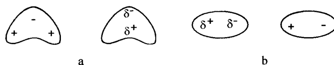
Figura 3.4- Representação de dipolos eléctricos em a. \text{H}_2\text{O} ; b. \text{HCl} .
