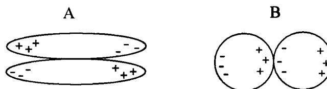
Figura 3.22- Interpretação dos pontos de ebulição de pentano (A) e de tetrametilmetano (B). Em A, os dipolos instantâneos tendem a interagir com maior intensidade que em B, devido ao facto de a forma da nuvem electrónica permitir uma maior superfície de contacto. Adaptado de Atkins e Jones, 2000.
