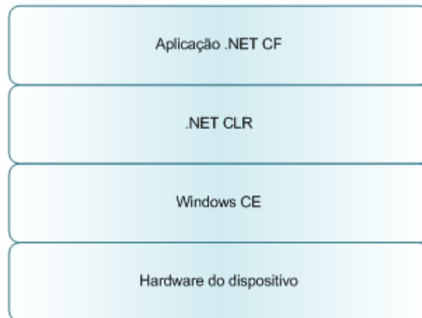
Fig. 15: Arquitectura de um ambiente .NET CF.
