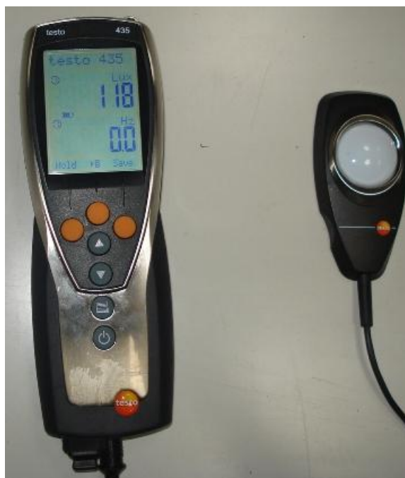
Figura 2.42 - Multifunções - Testo 435 com sonda de iluminação (lux) [Fotografia da autora]
