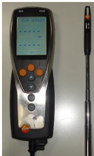
Figura 2.38 – Multifunções - Testo 435 com sonda térmica [Fotografia da autora]
