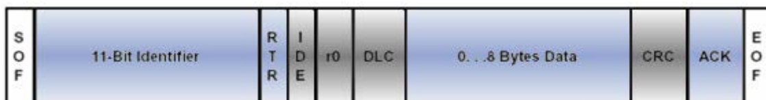
Figura 3.5 - Formato de uma trama CAN 2.0A
