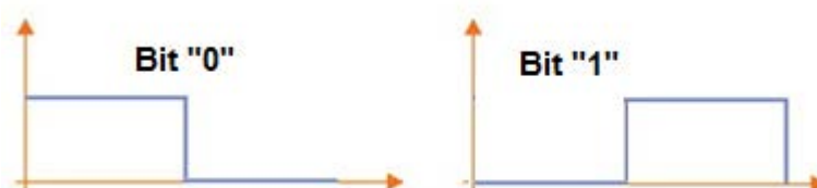
Figura 1.2 - Codificação dos bits no protocolo RC5
