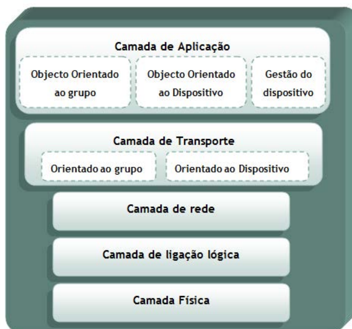
Figura 2.9 - Camadas OSI do sistema EIB/KNX
