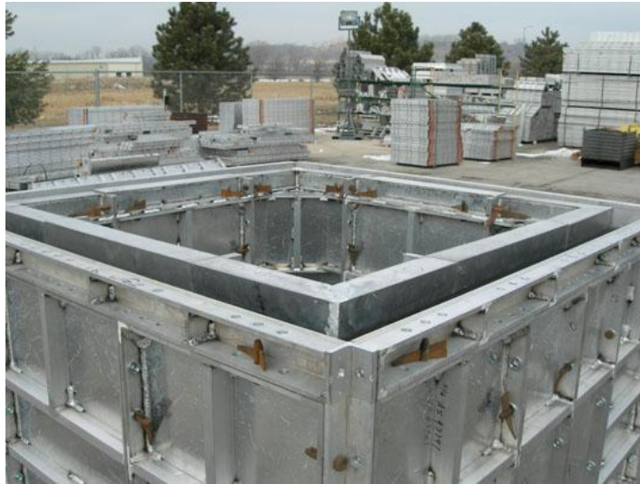
Fig. 15 – Molde de pré-fabricação ( Engenhariacivil.com , 2011)
