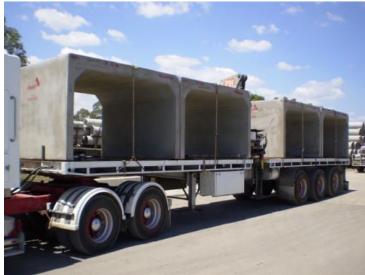
Fig. 11 – Exemplo do transporte de passagens inferiores do tipo box-culvert (Rocla, 2011)
