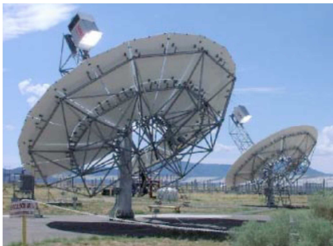
Figura 5 – Concentrador e Motor Stirling em testes na National Solar Thermal Test Facility em Sandia (Estados Unidos da América) [11]
