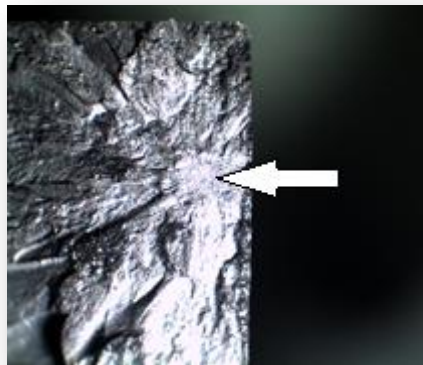
Figura 35: Superfície de fractura de provetes maquinados a partir de blocos dos graus da DURIT: a) defeito crítico superficial de um provete com programa de desbaste; b) defeito crítico superficial de um provete com programa de acabamento.
