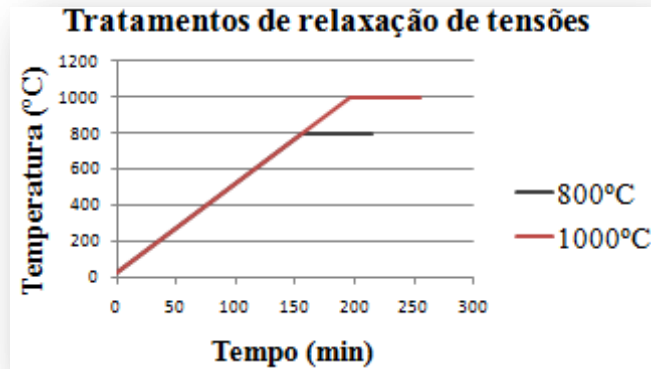
Figura 23: Ciclos dos tratamentos térmicos de relaxação de tensões residuais a 800 e 1000°C.
