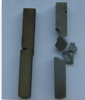
Figura 33: Fractura de um provete maquinado com programa de desbaste (à esquerda) e de rectificação e polimento (à direita).
