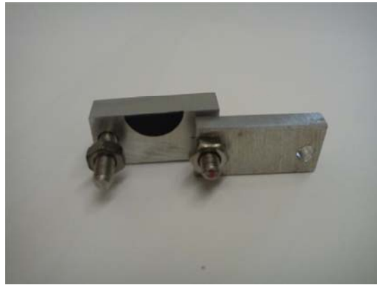
Figura 5- Suporte de montagem para observação da superfície de fratura.
