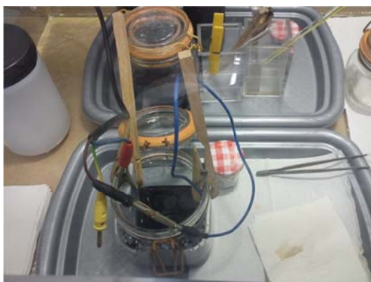
Figura 4- Célula eletrolítica da deposição de Al sobre um substrato de grafite.
