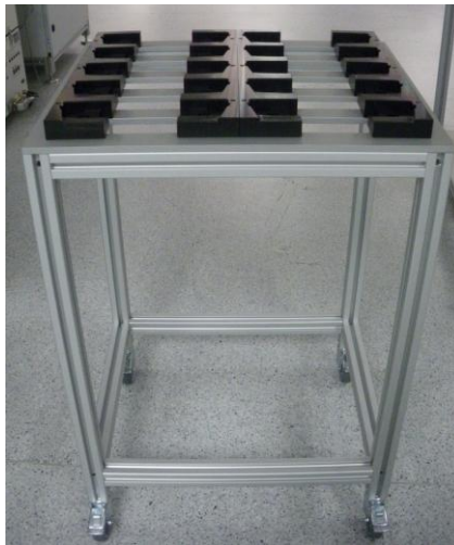
Figura IV.3.3 – Carro que transporta o material da linha de montagem para a linha de testes
