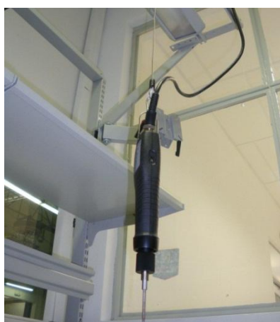
Figura IV.1.1 – Aparafusadora eléctrica na estação de rework
