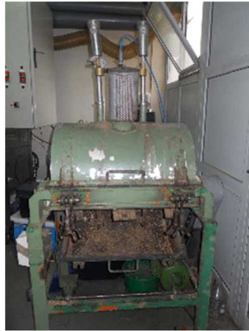
Figura 4. Encoladora do laboratório da FEUP
