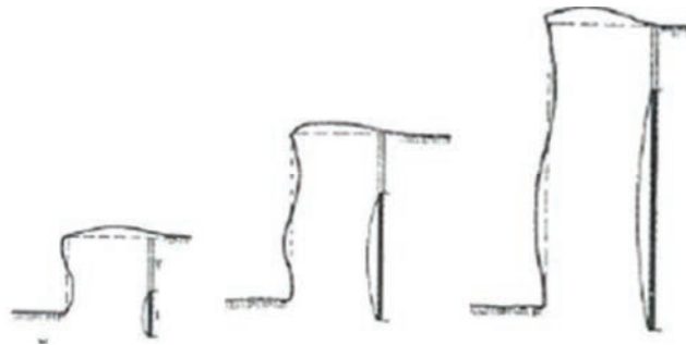
Fig. 5.5 – Estados de flexão de uma bancada com várias relações de K/V: K/V=1; K/V=2; K/V=3 (Jimeno et al., 2003)
