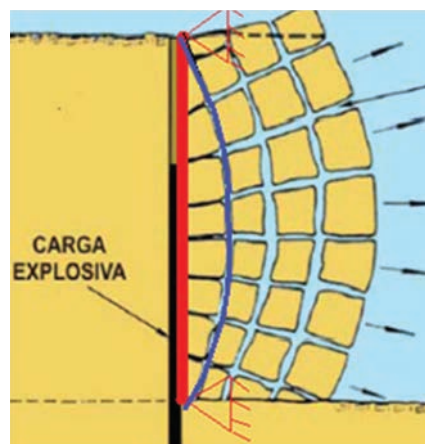
Fig. 4.8 – Esquema estrutural de funcionamento do desmonte
