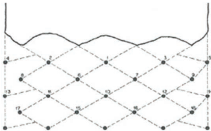
Fig. 5.8 – Geometria da frente livre e sequência de detonação (Jimeno et al.,2003)
