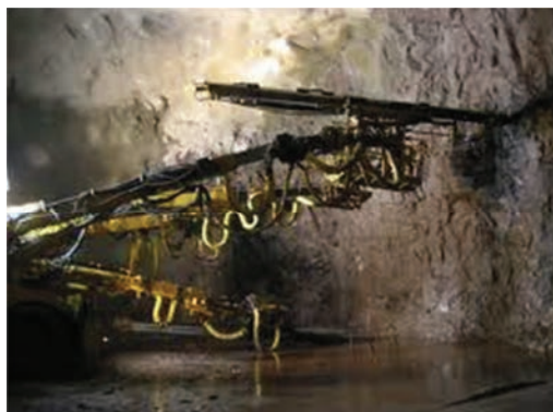
Fig. 2.7 – Jumbo hidráulico de 3 braços para perfuração em subterrâneo ( http://www.mch.cl/revistas/imagenes/xbnxbnx.JPG )
