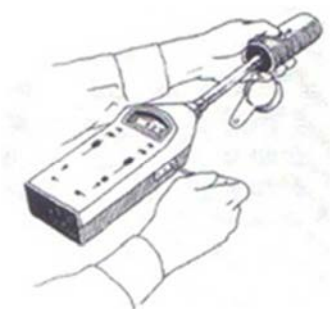
Fig. 3.9: Utilização de um calibrador sonoro num antigo sonómetro B&K [23].
