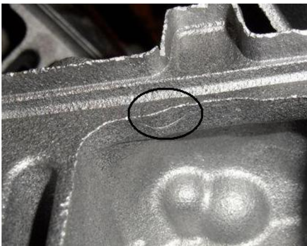
Fig. 64 - Defeito detectado, possivelmente metal frio nas peças.
