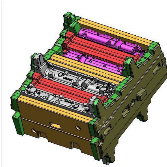
Fig. 14 - Imagem representativa de um dos blocos principais de machos constituídos por 4 subconjuntos
