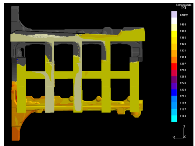
Fig. 59 - Corte efectuado no sistema de gitagem no modelo mais próximo do gito de descida.
