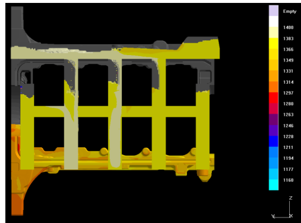
Fig. 61 - Corte efectuado no sistema de gitagem no modelo mais próximo do gito de descida.
