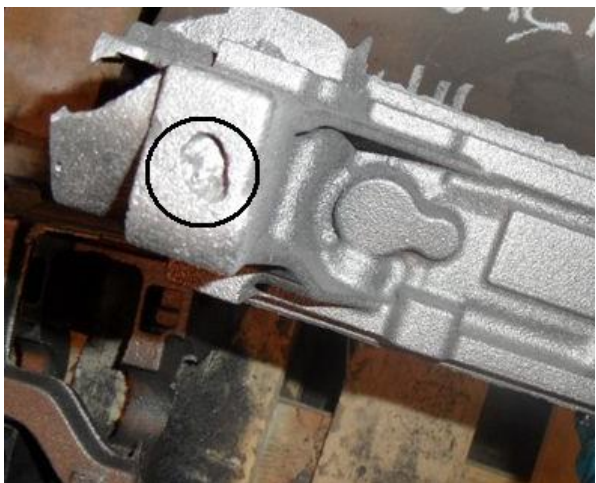
Fig. 65 - Defeito detectado em algumas moldações, acumulação de gases nas peças.
