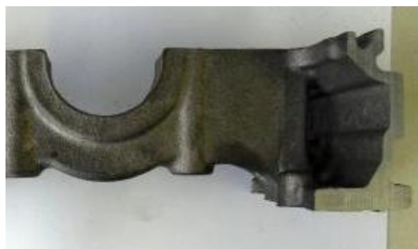
Fig. 68 - Corte efectuado numa das zonas mais finas do modelo. Vazamento do sistema de gitagem de série.
