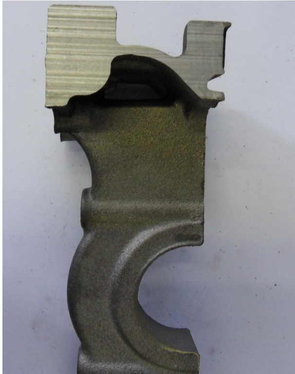
Fig. 72 - Corte efectuado na numa outra zona maciça da peça.
