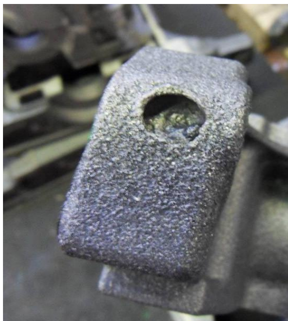
Fig. 16 - Um dos defeitos mais encontrado nas zonas das sapatas, bolhas.
