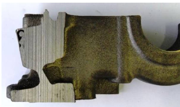
Fig. 67 - Defeito visualizado em raios-x após análise visual.
