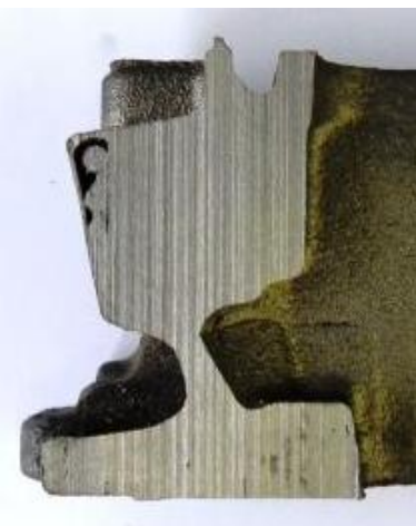
Fig. 19 - Defeito encontrado em algumas peças após controlo por ultra-sons.
