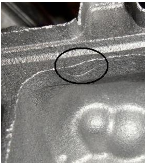
Fig. 17 - Defeito assinalado e considerado como junta fria.
