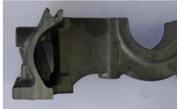
Fig. 70 - Corte efectuado numa terceira secção fina da peça.
