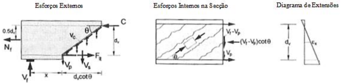
Figura 2. 11 – Esforços de uma viga e respectivo diagrama de extensões (adaptado de Bentz, 2010).
