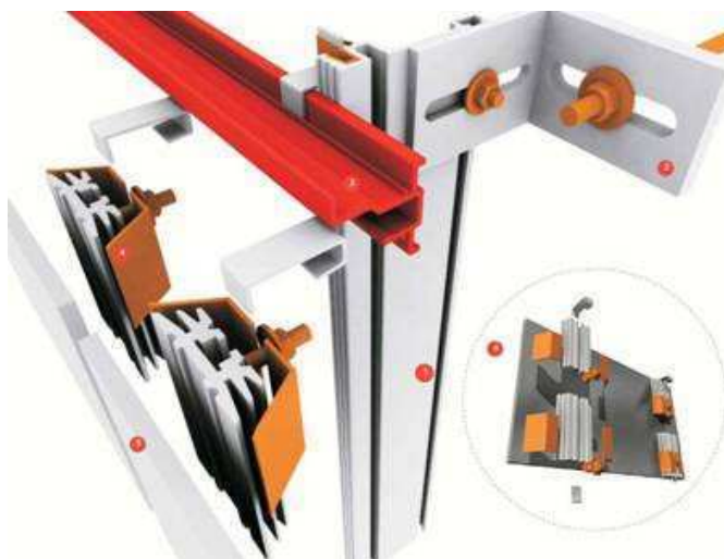
Fig. 2.30 - Fixação oculta para elementos de espessura fina, [29].
