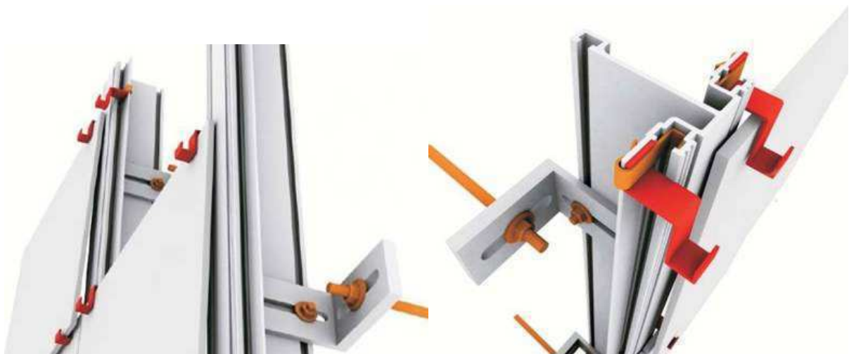
Fig. 2.29 - Sistema de fixação com sobreposição de painéis, [29].
