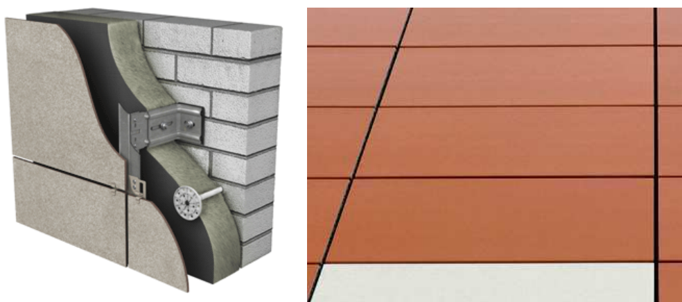
Fig. 2.2 – Junta aberta entre elementos do revestimento.
