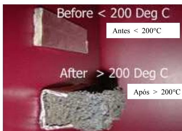
Fig. 5.8 – Barreira corta-fogo - antes e após exposição ao fogo, [50].
