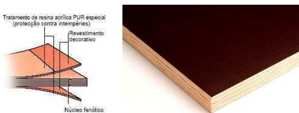
Fig. 2.15 – Composição de painel fenólico, [17].
