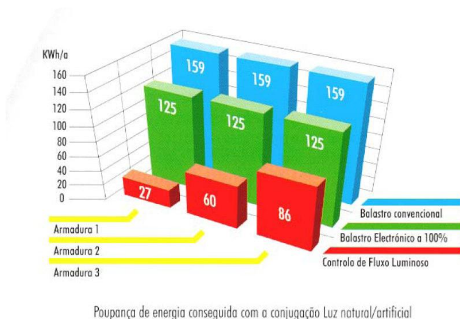
Figura 2.5 - Consumo de energia de sistemas com balastros convencionais/electrónicos [13]
