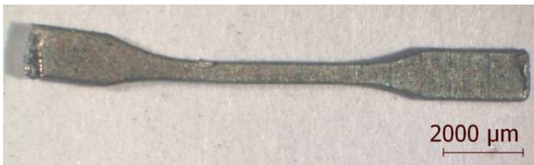
Figura 40 – Deformação causada durante separação dos provetes do sistema de gitagem (C36).
