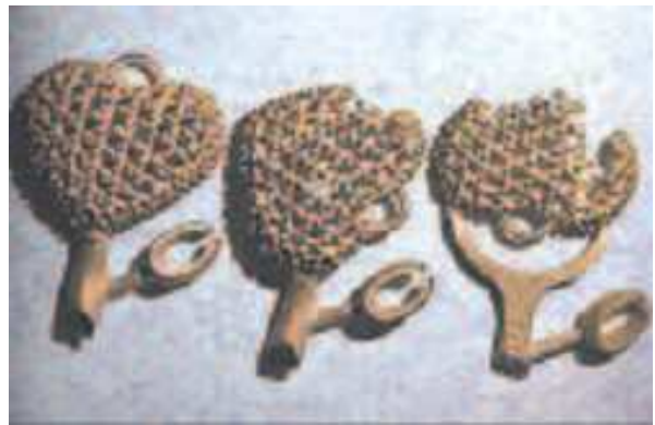
Figura 6 - Enchimento incompleto e a influência do sistema de gitagem [16].
