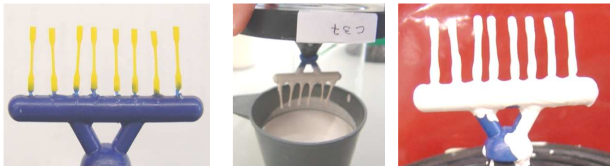
Figura 20 – Procedimento de revestimento por mergulho do modelo do cacho em babotina de zircónia.
