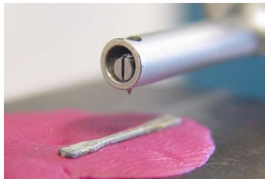
Figura 25 – Ensaio de rugosidade realizado num rugosímetro de contacto.
