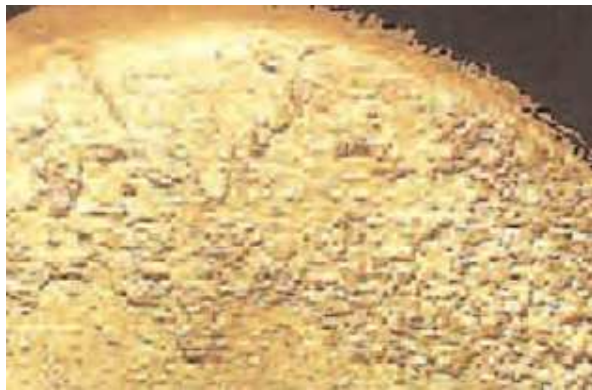
Figura 5 – Superfície granulosa numa peça de joalharia [14].
