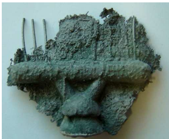
Figura 29 – Cacho vazado numa moldação de gesso a 470 °C (C5).
