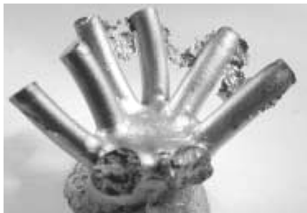
Figura 3 - Rebarba formada devido à fractura da moldação cerâmica [18].
