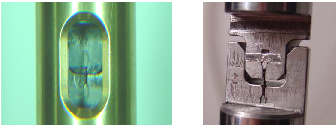
Figura 27 – Acessório desenvolvido para a realização dos ensaios de tracção. À direita apresenta-se um provete traccionado.
