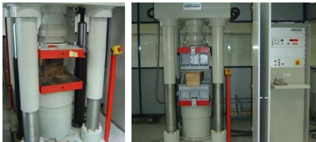
Fig. 4.4 - Ensaios mecânicos. Esquerda: ensaio à compressão; Direita: ensaio à flexão. (Franco, 2008).
