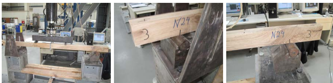
Fig. 5.21 - Materialização dos apoios. Esquerda: vista geral; Centro: pormenor do apoio esquerdo; Direita: pormenor do apoio direito.
