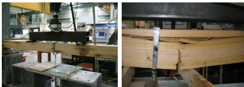
Fig. 4.11 - Ensaio à flexão. Esquerda: setup do ensaio; Direita: rotura por tracção paralela na zona traccionada. (Pereira, 2009).
