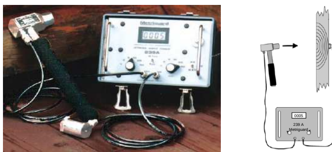
Fig. 3.12 – Metriguard . Esquerda: equipamento; Direita: funcionamento. (Fonte: http://metriguard.com ).
