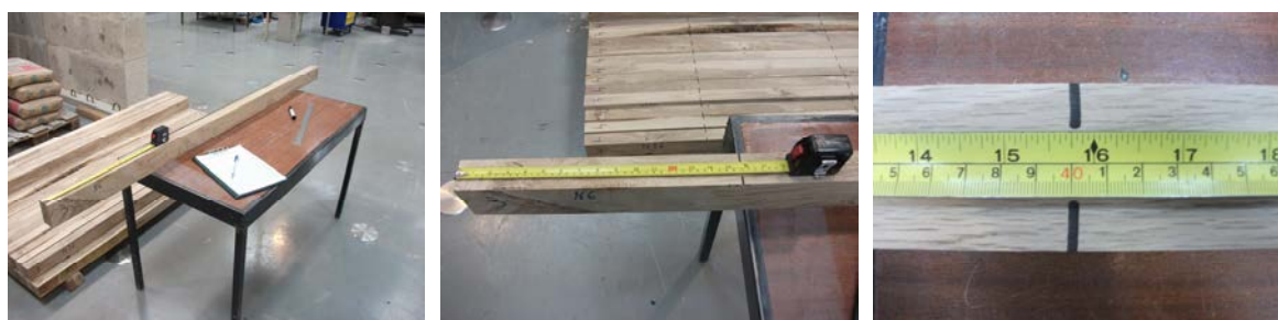
Fig. 5.12 - Marcação de uma das secções medidas na viga N6.
