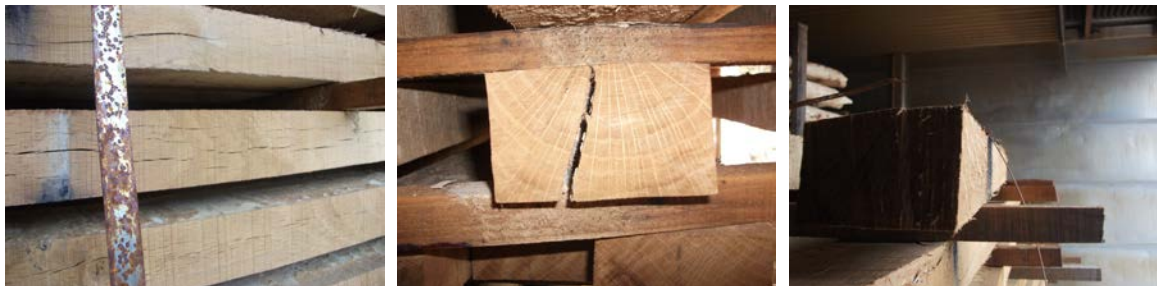
Fig. 5.7 - Defeitos de secagem. Esquerda: fendas longitudinais; Centro: fenda radial; Direita: distorção e empeno.
