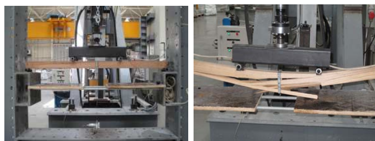
Fig. 4.20 - Ensaio à flexão. Esquerda: setup do ensaio; Direita: rotura por tracção paralela na zona traccionada. (Ramos, 2010).
