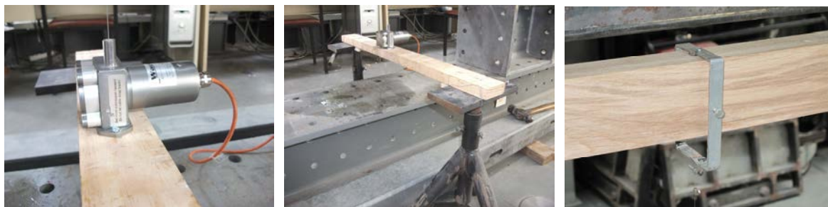
Fig. 5.20 - Medição de deslocamentos. Esquerda: LVDT; Centro: tripé de apoio; Direita: peça de fixação à viga.
