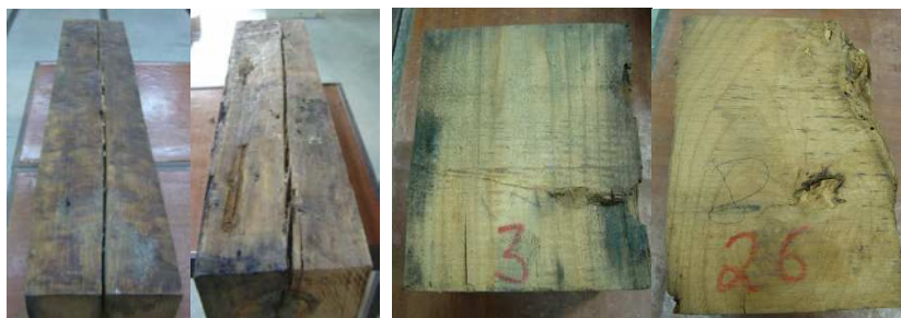
Fig. 4.2 - Aspecto final dos provetes antes dos ensaios mecânicos. Esquerda: provetes ensaiados à flexão; Direita: provetes ensaiados à compressão e respectiva identificação. (Franco, 2008).
