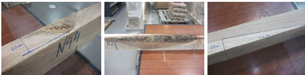
Fig. 5.14 - Exemplo de alguns defeitos medidos. Esquerda: nó - provete N44; Centro: descaio - provete N22; Direita: inclinação do fio - provete N45.
