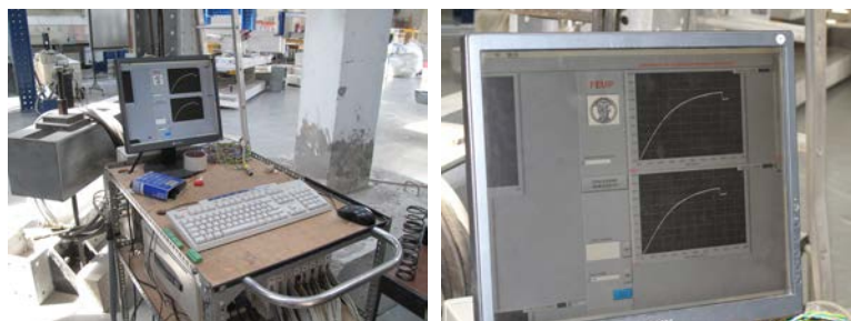
Fig. 5.22 - Monitorização do ensaio. Esquerda: aquisição de dados; Direita: gráfico força – deslocamento.
