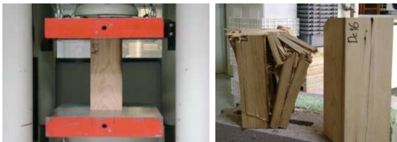
Fig. 4.12 - Ensaio à compressão. Esquerda: setup do ensaio; Direita: provete antes e depois do ensaio. (Pereira, 2009).
