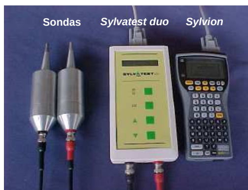
Fig. 3.4 – Componentes do equipamento Sylvatest (adaptado de Candian, 2007).
