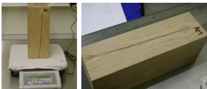
Fig. 4.10 - Avaliação da massa volúmica do provete Ac1. Esquerda: pesagem; Direita: medições. (Pereira, 2009).
