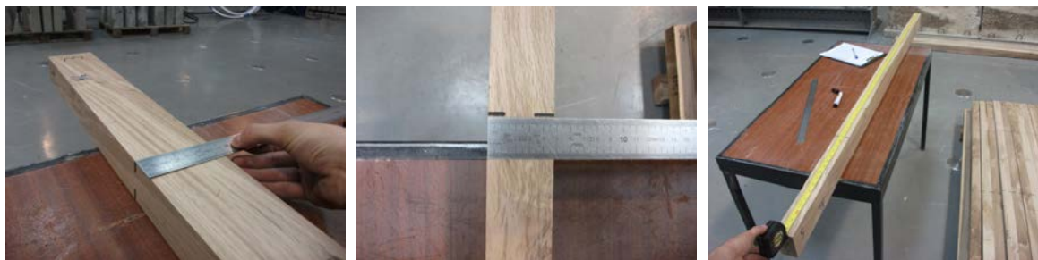
Fig. 5.11 – Medição das dimensões do provete N6. Esquerda: medição da altura ( h ); Centro: medição da largura ( b ); Direita: medição do comprimento ( L ).
