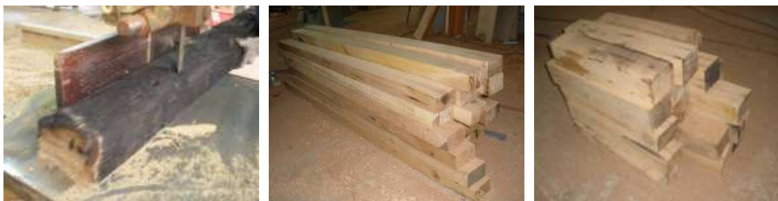
Fig. 4.8 - Preparação dos provetes de Carvalho. Esquerda: serração da viga; Centro: aspecto final dos provetes ensaiados à flexão; Direita: aspecto final dos provetes ensaiados à compressão. (Pereira, 2009).
