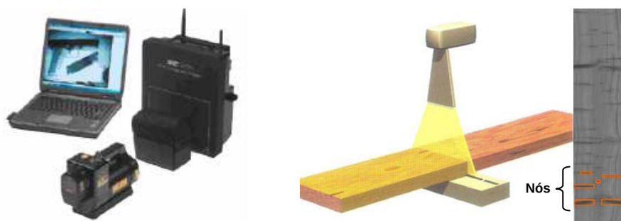
Fig. 3.13 - Raios-X. Esquerda: equipamentos para aplicação da técnica (Botelho, 2006); Direita: funcionamento e resultado (fonte: http://coste53.net ).
