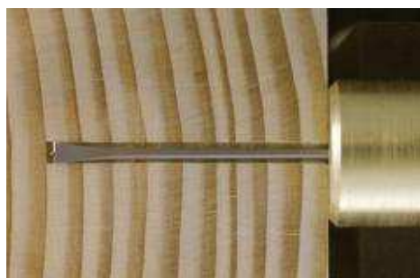
Fig. 3.7 – Agulha de perfuração do Resistógrafo (fonte: http://imldistribution.com ).
