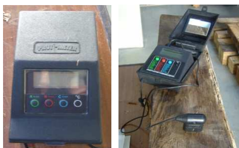
Fig. 4.3 - Avaliação do teor de água. Esquerda: Humidímetro ; Direita: medição expedita. (Franco, 2008).
