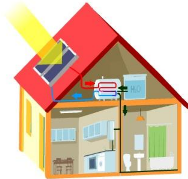
Figura 3.12 - Esquema ilustrativo de como os painéis solares térmicos aquecem a água para posteriores usos sanitários [39].
