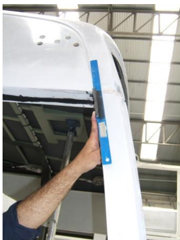
Figura 30 - Meio auxiliar de produção para alinhamento da pintura à volta dos retrovisores com as cornijas
