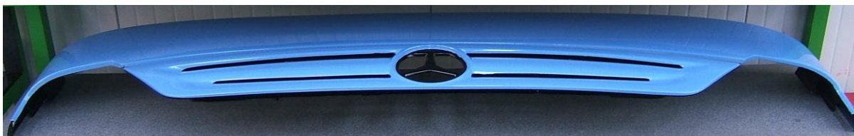
Figura 18 – Grelha e frente amovível desmontadas do autocarro
