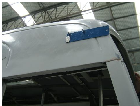
Figura 31 - Meio auxiliar de produção para definição da faixa por trás dos retrovisores
