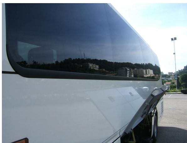
Figura 27 – Frisos entre painéis e vidros
