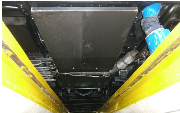
Figura 14 – Encapsulamento do motor montado na fossa
