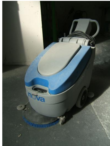
Figura 37 – Máquina de lavagem do chão das cabines de esmaltagem
