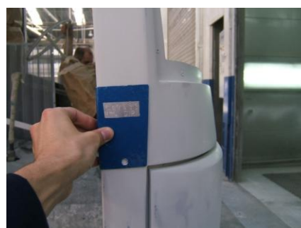
Figura 33 – Meio auxiliar de produção para alinhar o preto do "H" com a borracha do pára-brisas
