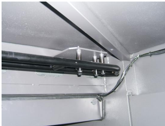
Figura 17 – Espelho da bagageira montado no suporte com a furação correcta
