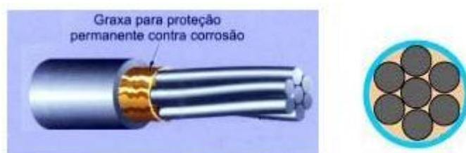
Fig. 3.1 – Cordão de pré-esforço.
