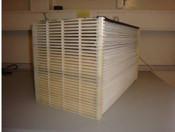
Figura 10 Aspecto do permutador
