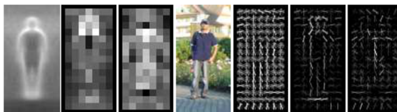
Figura 2.13: Exemplo de detecção de uma pessoa, utilizando o Histograma de Gradientes Orientados
