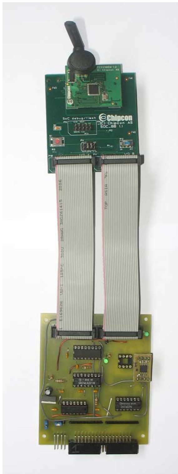
Figura A.3: Protótipo do emulador ligado ao módulo SoC_BB
