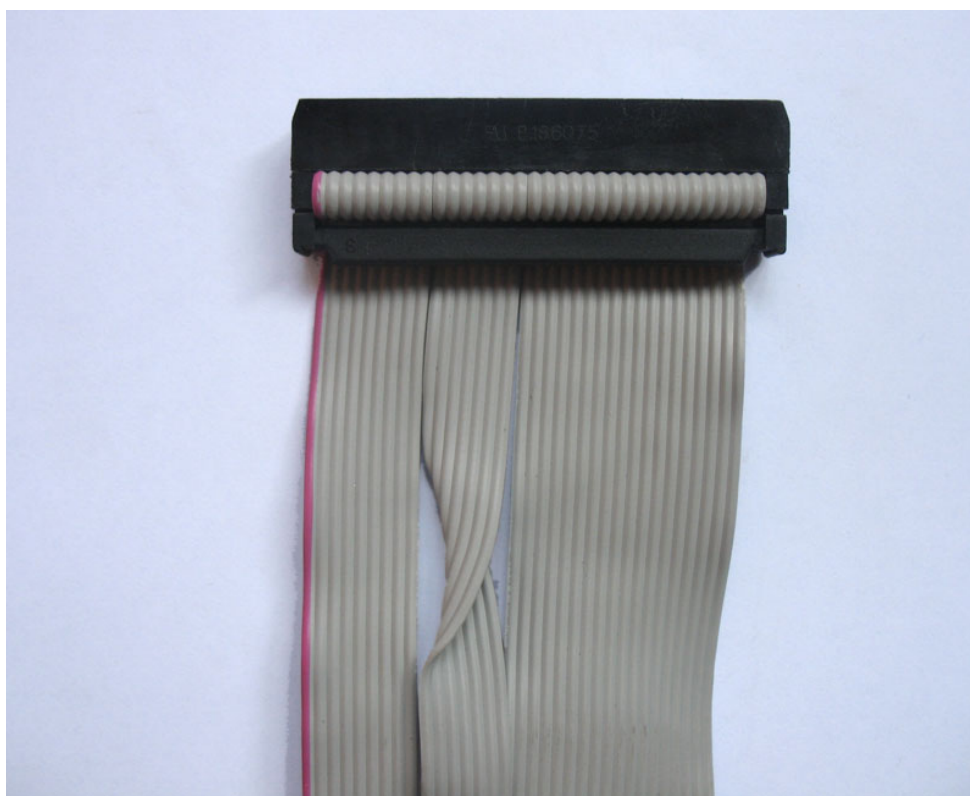
Figura 3.3: Cabo de dados com inversão de sinais de seleção de drive e conetor IDC.
