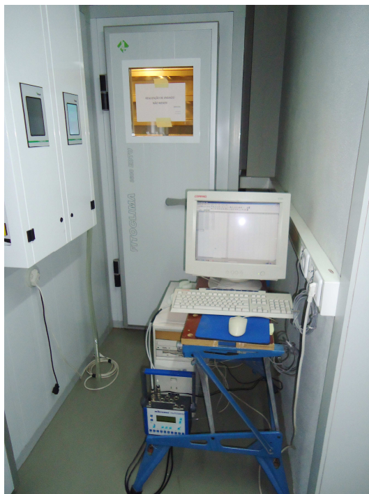
Fig.4.4 – Computador ligado à balança no interior da câmara climática para registo de dados e Datalogger
