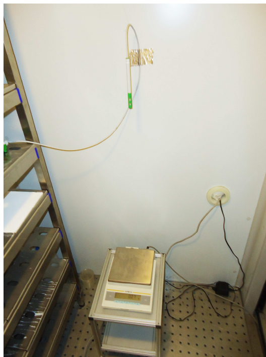
Fig.4.3 – Instalação do anemómetro e da balança
