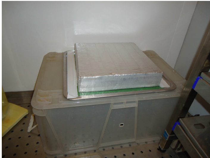
Fig.4.6 – Colocação da amostra a humedecer
