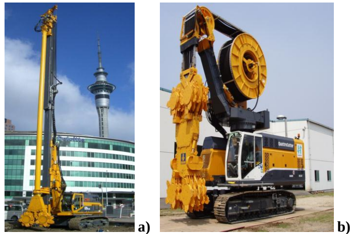
Fig. 2.34 – Diferentes tipos de máquinas de execução da técnica: a) RG 19T Profundidade máxima de 18 m; b) SideCutter profundidade máxima 60 m (Peixoto 2011)
