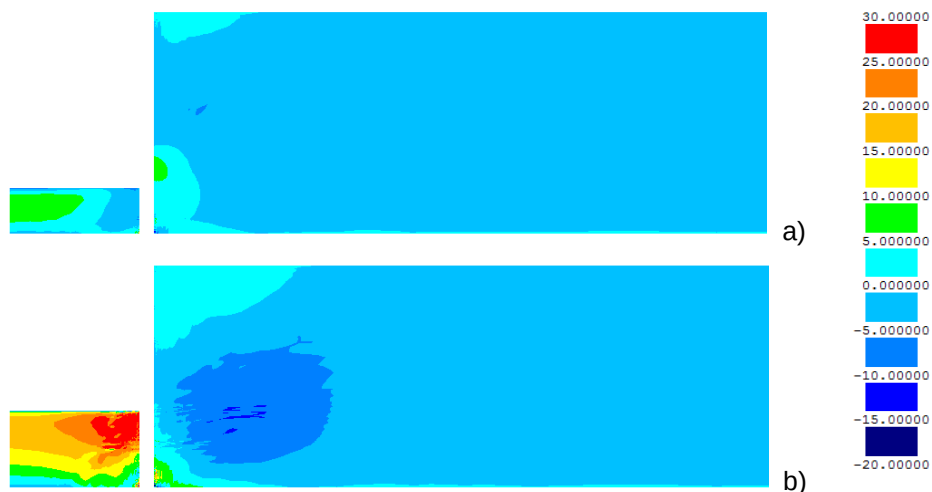
Fig. 5.4 – Incrementos de tensão efectiva horizontal na argila mole no final da escavação: a) estudo base; b) sem laje de fundo
