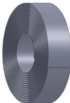
Figura 4.16: Núcleo de ferro laminado na direcção radial.
