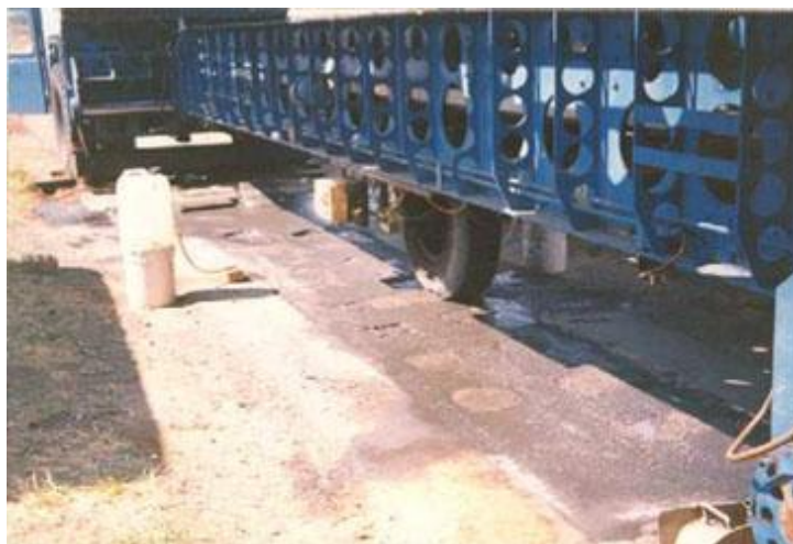
Figura 1-6 - Sistema de ensaio do HVS
