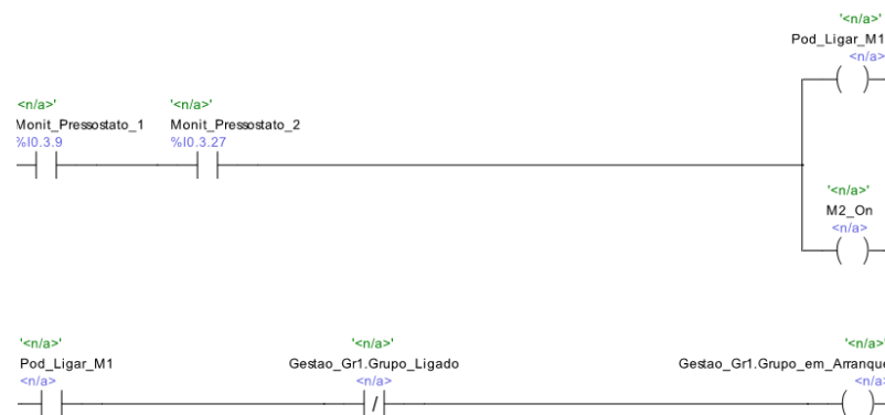
Figura 4-23 - Ordem de arranque para o motor M1
