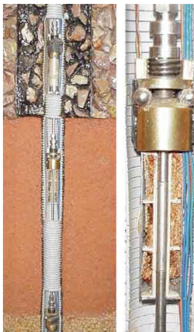
Figura 1-3 - “Multi-depth deflectometer” inserido no piso
