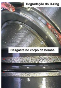
Figura 3.1 – Corpo da bomba da unidade injectora - Pressão mais alta na entrada do combustível quando a válvula solenóide se abre (O-Ring do corpo da bomba sofre carga mecânica maior); Maior movimento relativo da unidade injectora (desgaste elevado no corpo da bomba). [7]
