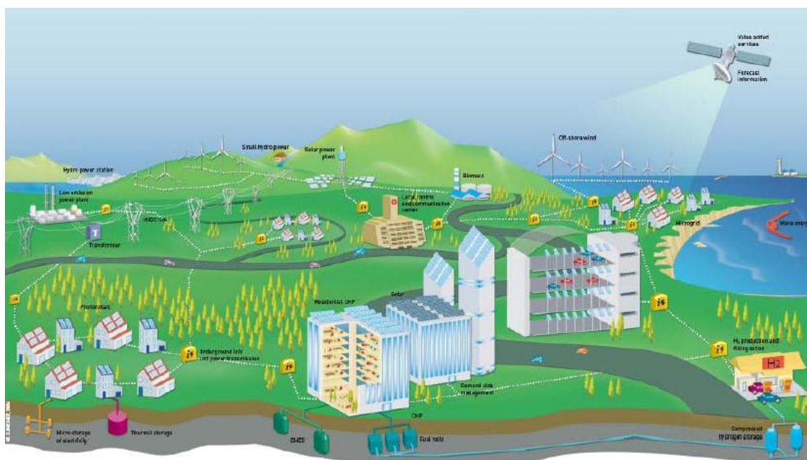
Figura 2.1 - Visão Smart Grid para as redes eléctricas [2]
