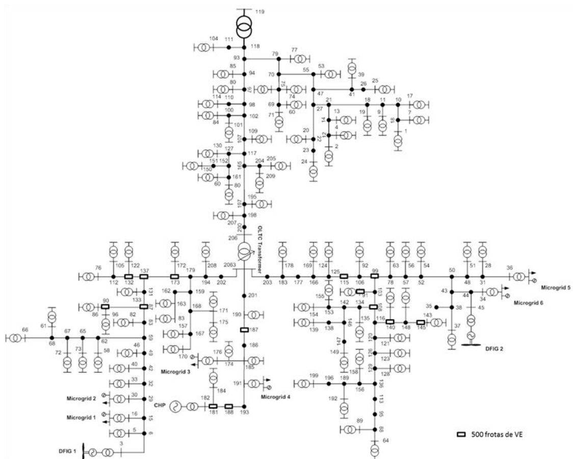
Figura 5.15 - Esquema unifilar da rede teste incluindo a ligação de frotas de VE
