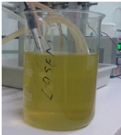
Figura 4.28: Fotografia da solução de sulfato de potássio ao final do experimento de ED com adição de ácido cítrico à solução de eletrodos.
