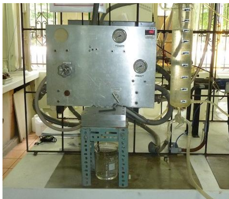
Figura A.1: Fotografia do equipamento utilizado para os testes de caracterização da membrana.
