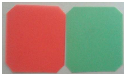
Figura 3.5: Membranas de ED, catiônica (esquerda) e aniônica (direita).
