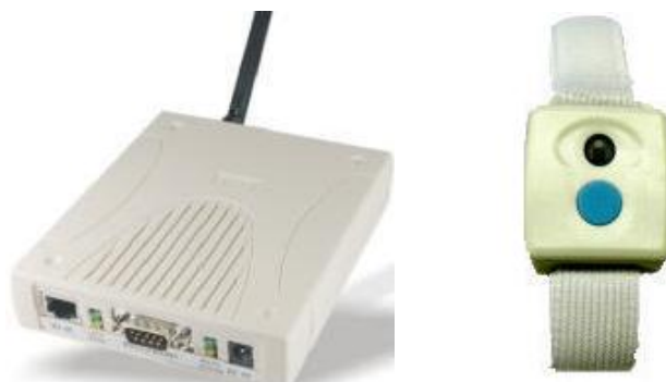
Figura 2.8 - Reader RFID SYRD245-1N e tag RFID activa SYTAG245245_TM.
