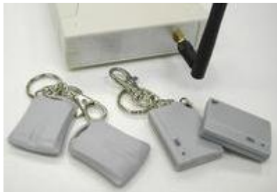
Figura 2.9 - Aspecto do reader e tags utilizados.
