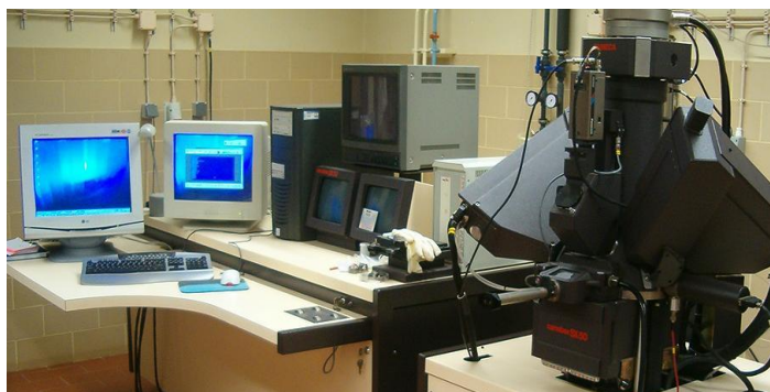
FIGURA 33- Microsonda electrónica utilizada para determinar a composição química dos filmes após a deposição.
