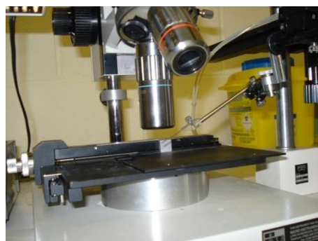
FIGURA 41- Micromanipulador utilizado para transferir a amostra para a grelha de cobre.
