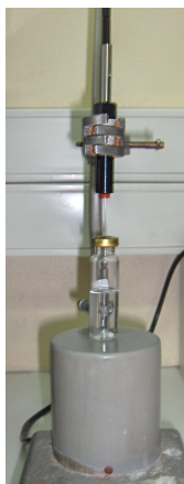
Figura 5 – Extracção de clorofórmio com fibra de 65 µm PDMS/DVB em headspace .
