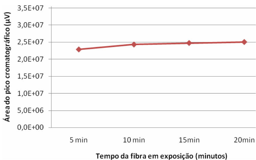
Figura 13 - Extração de clorofórmio ao longo do tempo com a fibra PDMS/DVB.
