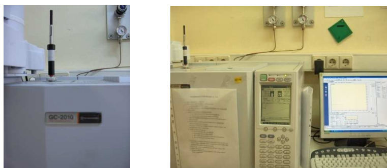
Figura 4 - Equipamento de cromatografia gasosa com detector de captura de electrões.
