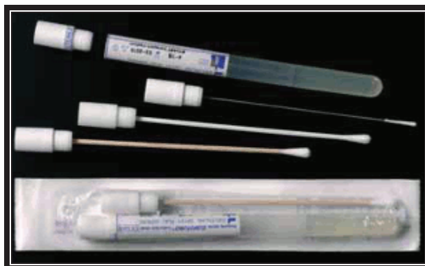
Figura 6: Meio de transporte de Stuart, composto por zaragatoa e tubo fechado, contendo o meio (Adaptado de: Labset, 2007)
