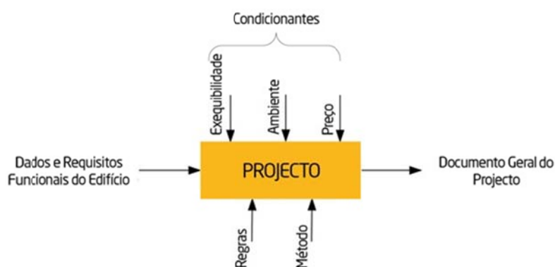
Figura 3 – Diagrama geral de elaboração de um projecto pelo projectista
