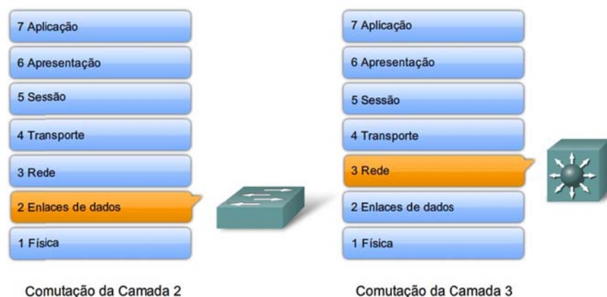
Figura 25 – Camadas do modelo OSI
