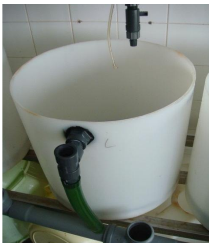
Figura 9. Tanque para larvas de lavagante.
