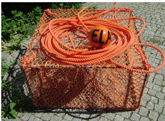
Figura 6. Nassa utilizada na pesca experimental.
