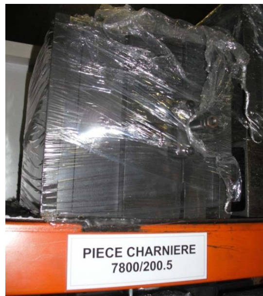
Figura 45 – Implementação da solução adoptada na identificação de um molde no seu espaço de armazenamento
