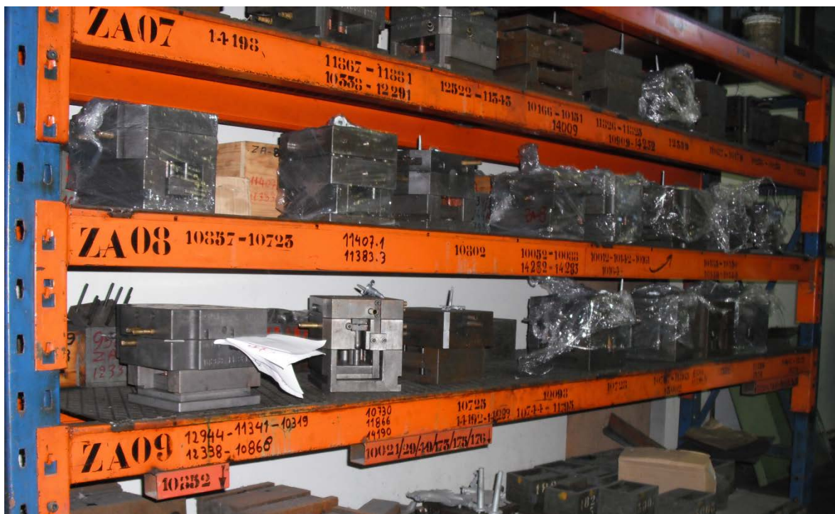
Figura 20 – Exemplo do sistema de codificação das localizações no espaço de armazenamento dos moldes/ferramentas
