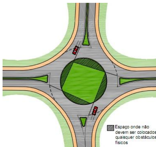
Figura 37 - Zonas de invasão da ilha central na sequência de um despiste frontal [Instituto de Infra-Estruturas Rodoviárias]
