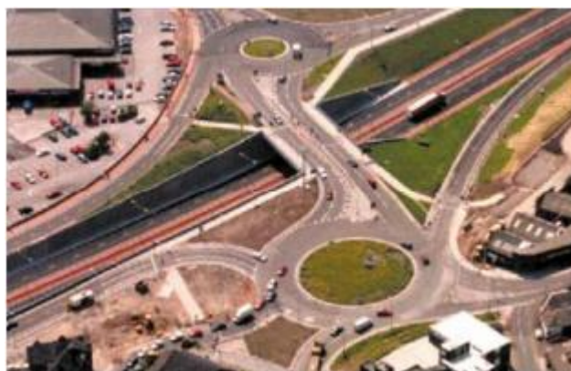
Figura 6 – Rotunda desnivelada interligada por um viaduto [Bastos Silva, 2001]
