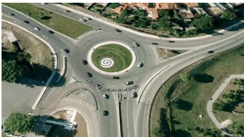
Figura 33- Exemplo de rotunda com movimento de viragem à direita [4]
