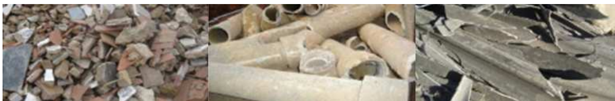
Fig. 3.1 – Constituição Heterogénea de RCD [15]
