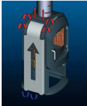
Figura 21 – Transferência de calor por convecção num recuperador de calor [www.jotul.com]
