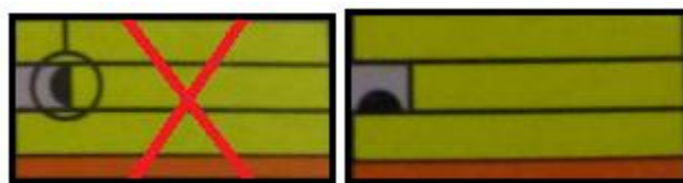
Fig. 5.6 – Aplicação correcta da cola. [3]
