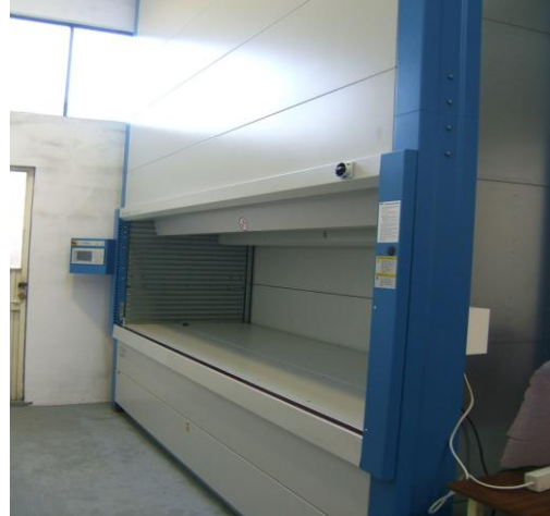
Figura 10: Equipamento Kardex da empresa STA (para armazenagem de componentes e em fase de implementação)
