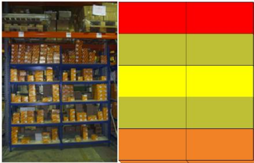
Figura 13: Pormenor de uma prateleira e “zona dourada” de utilização: a zona dourada localiza-se na zona central, as posições inferiores devem ser destinadas para arrumação de produtos pesados e a encarnado identifica-se a zona que se deve utilizar [14]
